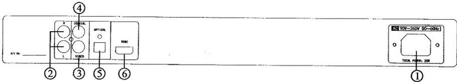
1. Conector de entrada de alimentación. Conecte a una toma de corriente alterna 90V ~ 260V.
